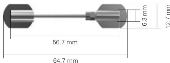
(1) Usando un factor de sensor, la frecuencia medida se puede convertir directamente a unidades de tensión.
